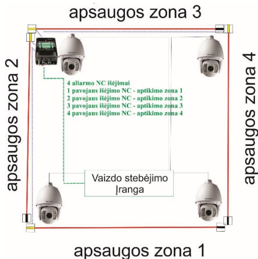
Pav. 22 „TRIBO-S“ PROCESORIUS SUMONTUOTAS NETOLI TVOROS AR PASTATE. TVOROS AUKŠTIS 1,5 METRO, REIKALINGA APTIKIMO ZONA 300 METRŲ.
