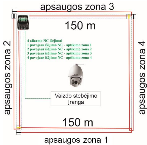
Pav. 21 „TRIBO-S“ PROCESORIUS SUMONTUOTAS ANT TVOROS. TVOROS AUKŠTIS 2 METRAI, REIKALINGA APTIKIMO ZONA 150 METRŲ.
